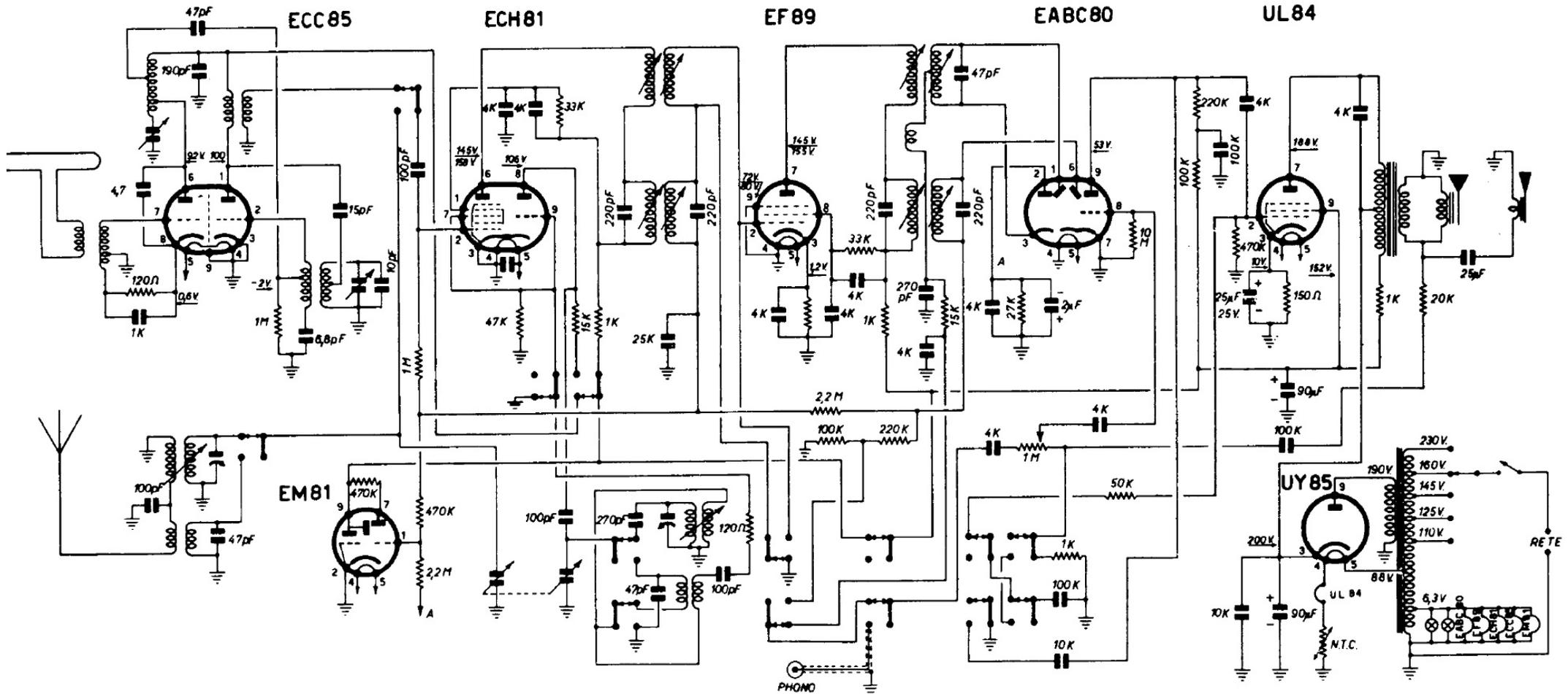
Radoricevitore a modulazione di frequenza FM/90
